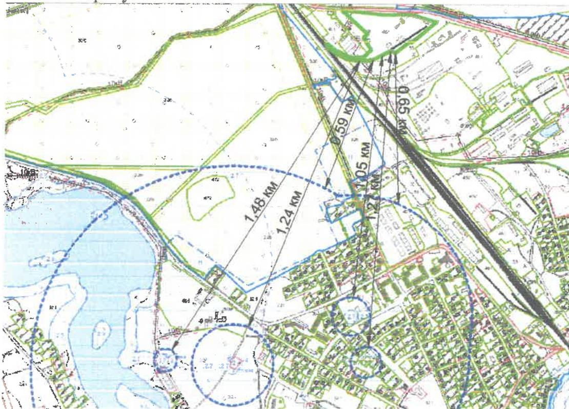
Рисунок 3.2 Схема расположения артезианских скважин г.п.Новоелья
